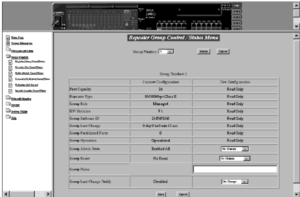
図 110. Repeater Group Control/Status Menu (リピーター・グループ制御/状況メニュー)
